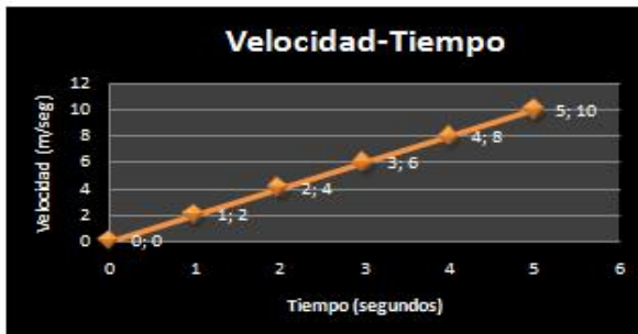
Gráfica 1. Esta grafica indica que la aceleración se mantuvo constante, el valor de la pendiente de la recta representa el valor de la aceleración del móvil.
