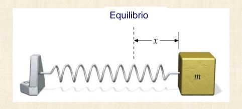
Un oscilador armónico ideal está formado por una masa m unida a un muelle de masa despreciable y constante elástica k
